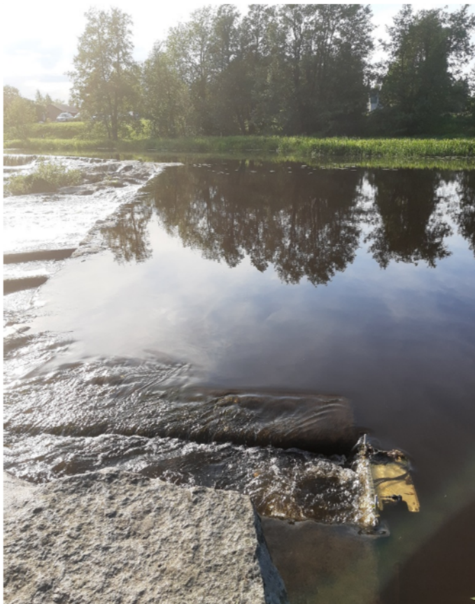
Kuva 2. Kalalaskuri asennettuna Kirkonkylänkosken kalatiehen kesäkuussa 2021.
