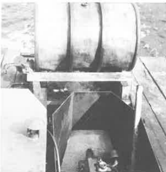
Lähikuva lautalle asennetusta pintavirrankehittimestä
