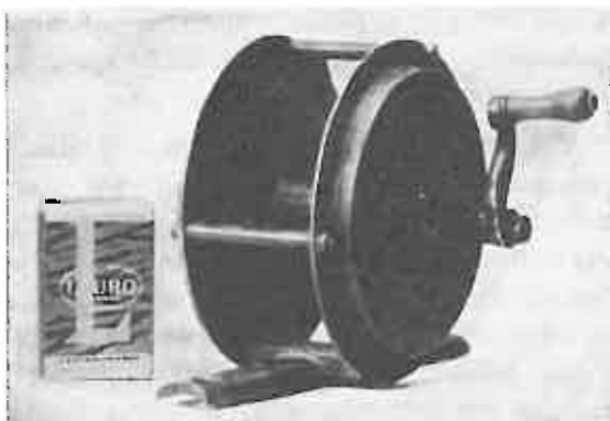
Kuva 55. Tampereläiset lohirissat olivat kuuluisia tukevasta rakenteestaan. Rissa oli puista kädensijaa ja rautaisia rattaita lukuunottamatta kokonaan joko vaskesta tai messingistä taottu. Siinä ei ollut muuta jarrulaitetta kuin veivin kahva, joka pyöri huomattavasti hitaammin kuin rissan rulla. Valok. Teuvo Nieminen.
